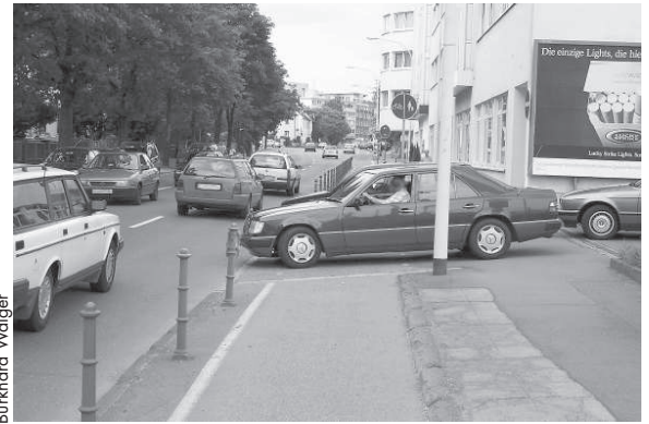
Die Poller sollen einerseits die Nutzung des Radwegs als KFZ-Parkplatz verhindern, andererseits unterbricht eine Grundstücksausfahrt den Radweg. Ja was denn nun?
