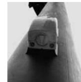
Vibrations- oder Anforderungstaster mit Richtungs- und Pfeil. Er befindet sich an allen Ampelmasten. Sobald bei Druck an der Unterseite der Taster vibriert, kann bei Grünphase die Straße gequert werden, begleitet vom Piepton der Akustik
